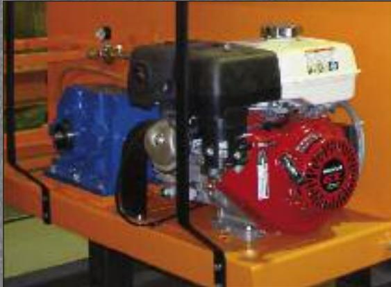
Nella serie ATC 25 l'azionamento è comandato da un motore a benzina Honda 9,0 PS / 6,7 KW con frizione centrifuga.
