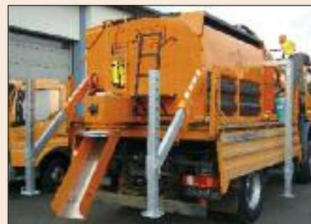
Per l'impiego di veicoli scarrabili, ASPHALT-THERMO-CONTAINER può essere equipaggiato con un carrello di carico (tipo ER).
