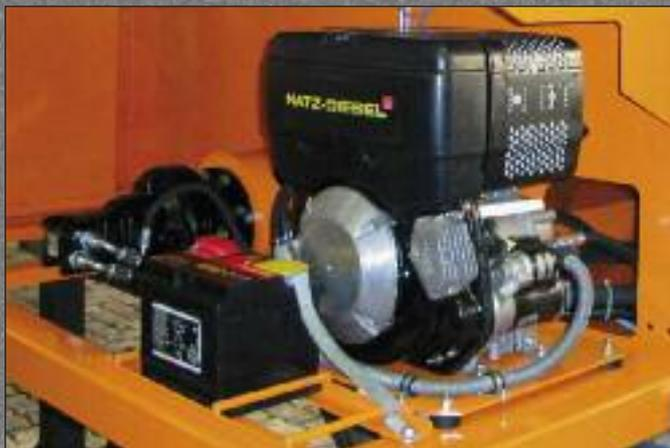
Motore diesel Hatz EHu, esecuzione aperta, 10,0 PS / 7,3 KW con sistema di avviamento elettrico e serbatoio idraulico da 50 litri.
