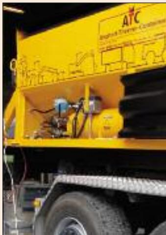
Spruzzatore per adesivo per l'applicazione dell'adesivo riscaldato (p.e. per adesivo B. UK60) e serbatoio di riserva, applicato sul fianco del container.
