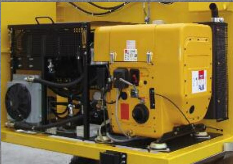
Motore diesel a quattro tempi Hatz EH a 1 cilindro 13,6 PS / 10 KW, esecuzione insonorizzata, serbatoio diesel da 21 l, serbatoio idraulico da 76 l (non rappresentato in fig.)
