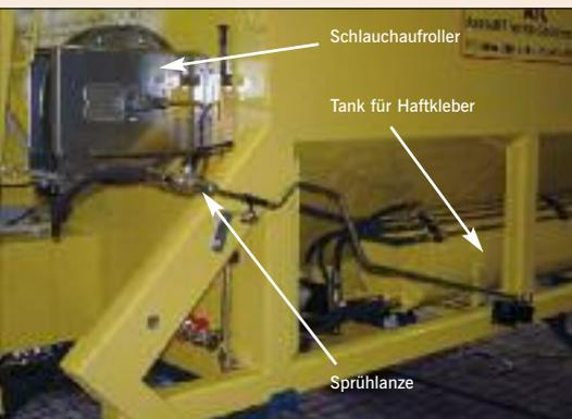
Lo spruzzatore per adesivo a comando idraulico consente l'applicazione rapida e semplice dell'adesivo a base di emulsione a freddo con una frazione massima di bitume del 40% per la preparazione delle aree da riparare.
